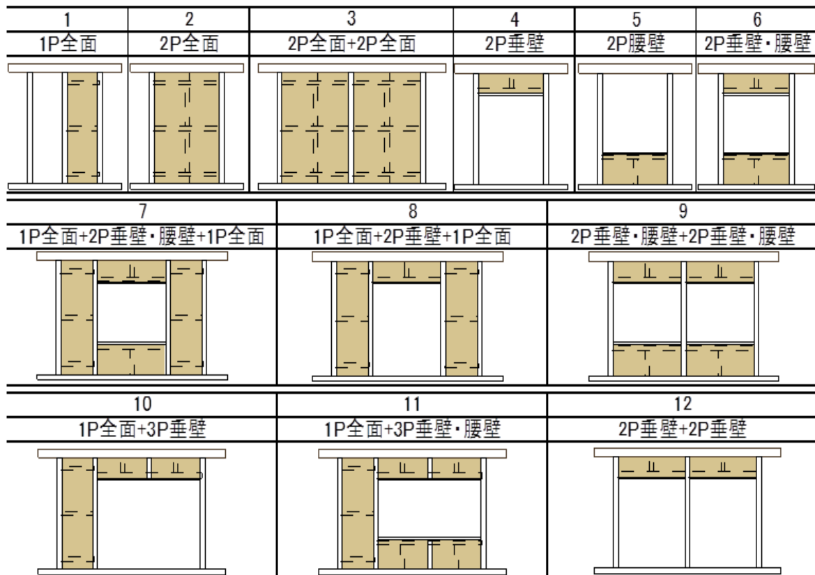
図2 土台仕様湿式土塗り壁試験体一覧
