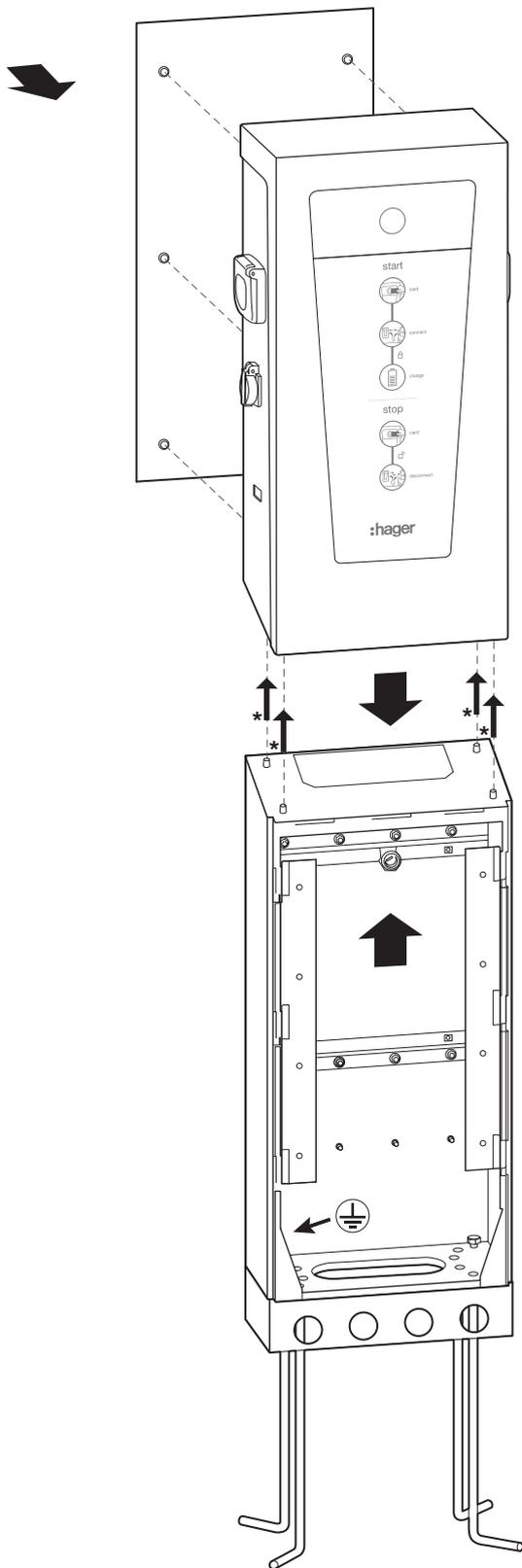
**!** La fixation de la borne sur le pied **DOIT** se faire **AVANT** la fixation du coffret vector. La liaison équipotentielle à la terre doit être réalisée entre la borne, le pied et le socle.
