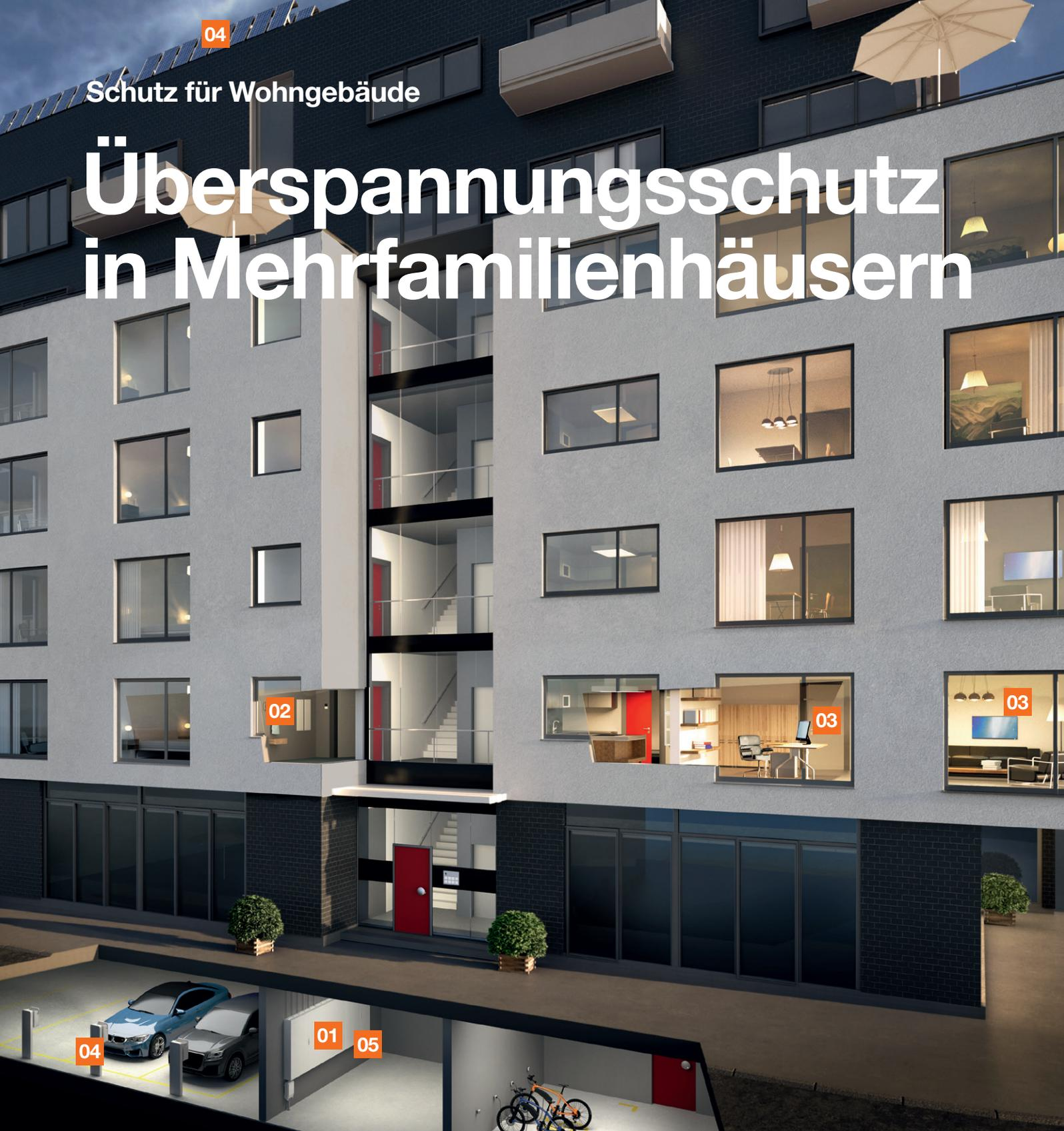
Im Vergleich zu Einfamilienhäusern ist der Anteil von Mehrfamilienhäusern mit Blitzschutzanforderung deutlich höher. Die SNR 464022 definiert, welche Bauten und Anlagen mit Blitzschutzsystemen zu schützen sind. Sie bietet eine gute Hilfestellung, klassifiziert Gebäudetypen und benennt die einzuhaltenden Blitzschutzklassen. Auch MFH ohne Blitzschutz benötigen einen Schutz gegen transiente Überspannung – für eine sichere Elektroinstallation.
