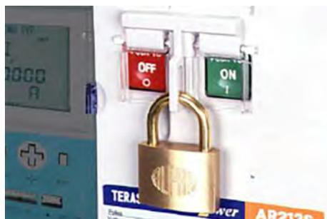
Die Tastenabdeckung des ACB-Einschubs kann mit Hilfe von bis zu drei Vorhängeschlössern mit Bügelstärke bis  $\varnothing$  6 mm gesichert werden, um Schalthandlungen am ACB durch unbefugte Personen zu verhindern.
