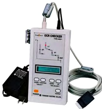
Das Prüfgerät "OCR Checker" für den Überstromauslöser ermöglicht das Prüfen von langzeitverzögerter Auslösung, kurzzeitverzögerter Auslösung, Sofortauslösung, Erdfehler-Auslösung und Vorauslöse-Alarmfunktion von Überstromauslösern am Einbauort.
