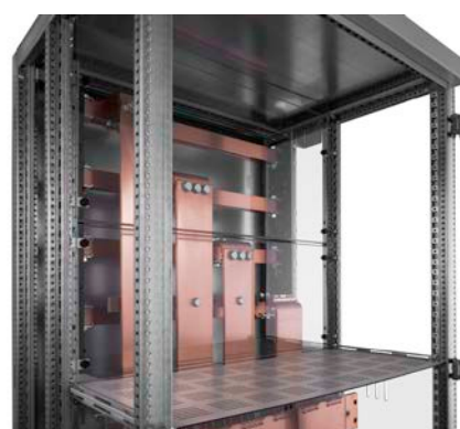
Berührungsschutz durch transparente, vorgezogene 2b-Schottung der Ausbaustufe 2 Form 2b. Die Schottung verhindert unbeabsichtigtes Berühren der Feldanbindung, auch bei geöffnetem Steuerfach
