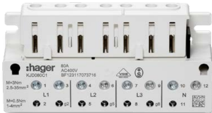
Zählersteckklemme 80 A mit Stecktechnik auf der Zählerseite, für Leiterquerschnitte von 2,5 bis 35 mm 2 Artikel-Nr.: KJD080C1 E-Nr.: 169 000 013
