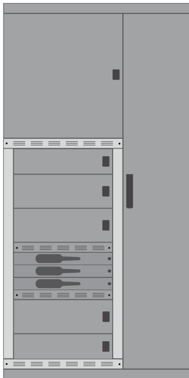
Schrankfront FE1 / HF Teilausbau mit Konvektion (Modultüren nicht dargestellt)
