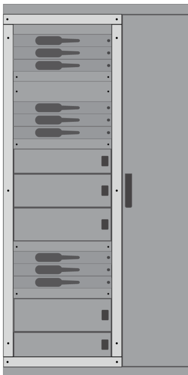
Modulfront FE1 Vollausbau ohne Konvektion (Modultüren nicht dargestellt)
