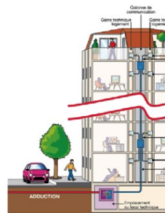
Installation avec PBO
