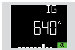
Instelling van de schakeldrempel met betrekking tot een aardfout.
