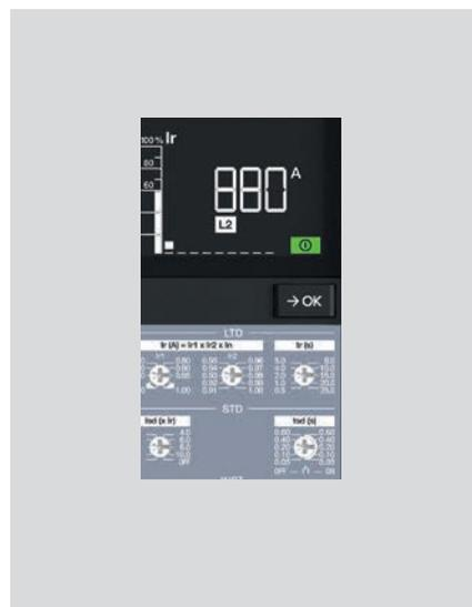
Maneja el dial para mostrar el valor de ajuste de un parámetro concreto.
