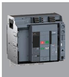
**HW1 de 4 polos, 66 kA, In máx. = 1600 A, tipo extraíble, con unidad de disparo sentinel LSI y módulo calibre relé In = 1600 A, conexiones posteriores horizontales tanto en la parte superior como en la inferior**
