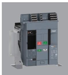
**HW1 de 4 polos, 66 kA, In máx. = 1600 A, tipo fijo, con unidad de disparo sentinel LSI y módulo calibre relé In = 1600 A, conexión frontal tanto en la parte superior como en la inferior**
