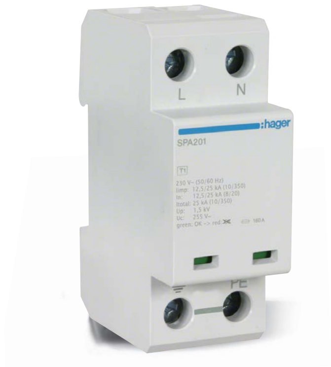
Descargador monobloc Tipo 1 + 2 Iimp: 12,5 / 25 kA (10/350) Up: 1,5 kV Norma IEC 61643-11
