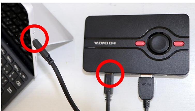
図 15. HDMI キャプチャーデバイスとパソコンを接続
