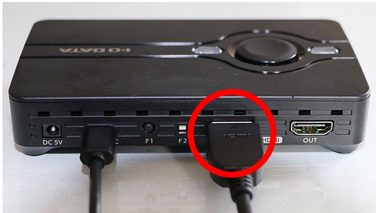
図 13. HDMI ケーブルを HDMI キャプチャーデバイスの HDMI IN に接続
