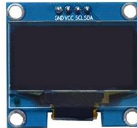
OLED Display 0.96 GP4 SDA y GP5 SCL
