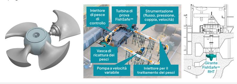
Progetto della girante della turbina FishSafe™
