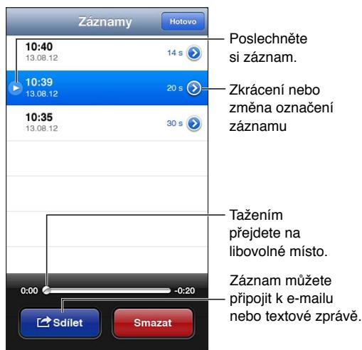
**Oříznutí záznamu:** Klepněte na u záznamu a poté klepněte na Oříznout záznam. Přetáhněte okraje zvukového regionu a poté klepněte na a poslechněte si výsledek. Podle potřeby jej upravte a pak uložte klepnutím na Oříznout. Oříznuté části nelze obnovit.
