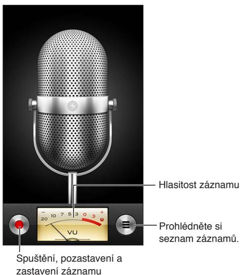
**Pořízení záznamu:** Klepněte na ●. Klepnutím na ▶ záznam pozastavíte, klepnutím na ■ jej zastavíte úplně.
