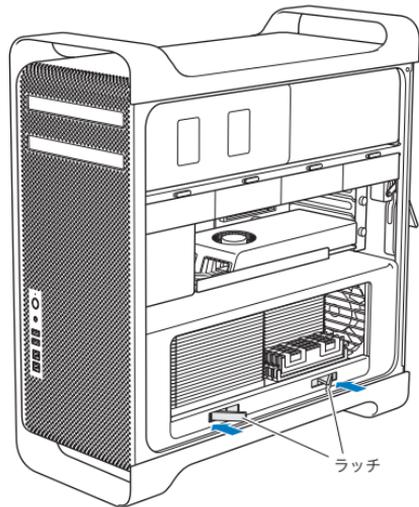
3 ラッチを引いて完全に開き、プロセッサトレイを解放します。
