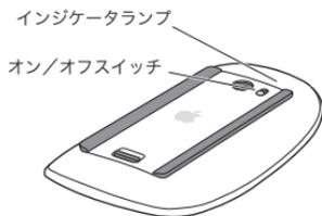
マウスの電源をはじめて入れると、インジケータランプが 5 秒間点灯し、電池の残量が十分あることが示されます。マウスの電源が入らない場合は、電池が正しく取り付けられ、充電されていることを確認してください（96 ページを参照）。
