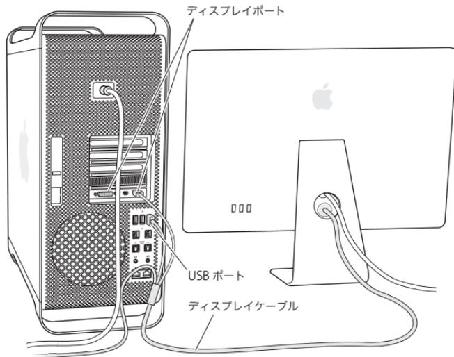
Mac Pro 背面のディスプレイポートに、Mini DisplayPort または DVI (Digital Visual Interface) コネクタのあるディスプレイを最高 3 台まで接続できます。DVI ディスプレイポートはデュアルリンクポートなので、30 インチの Apple Cinema HD Display を接続できます。
