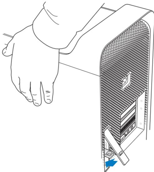
Mac Pro の盗難防止のために、金属の穴の部分に鍵やケーブルを取り付けることもできます。ラッチを閉じる前に金属の穴の部分押し下げてから、ラッチを閉じて金属の穴の部分に鍵やケーブルを取り付けます。
