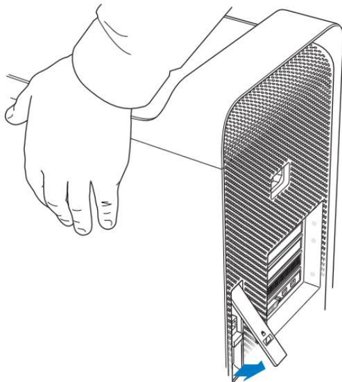
6 Mac Pro の側面パネルの上部を持ち上げながら手前に引っ張り、側面パネルを取り外します。
