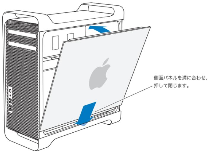
**注意：** 部品を取り付けた後は、側面パネルを必ず元に戻してください。Mac Pro は側面パネルを取り付けないと正しく動作しません。
