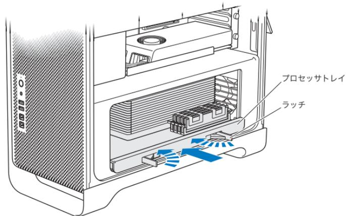
8 ラッチを最後まで押し込んで閉じ、プロセッサトレイを固定します。
