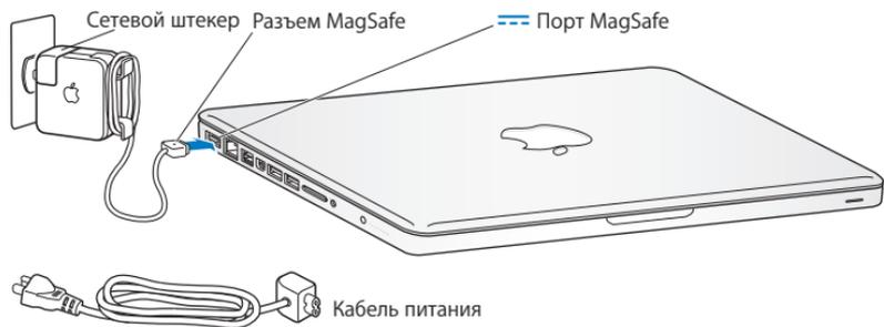
Перед подключением удлиняющего кабеля к адаптеру питания замените сетевой штекер на кабель питания. Сначала извлеките сетевой штекер из адаптера, а затем подсоедините прилагаемый кабель питания к адаптеру. Убедитесь при этом, что он надежно зафиксирован.
