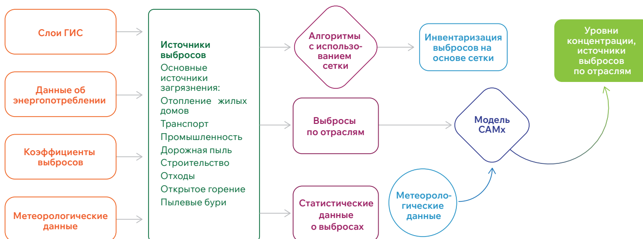
Рисунок 20: Структурная схема системы моделирования CAMx
