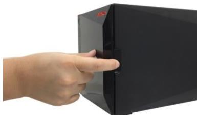
2. 依箭头方向, 将要安装硬盘的托盘拉取出来, 如下图所示。
