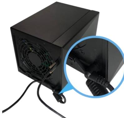
3. 将 AS5004U USB 3.2 Gen2 的线插到未开机 NAS 的 USB 3.2 填，当 NAS 开机时，AS5004U 也会开机。当 NAS 关机或休眠时，AS5004U 会进入休眠待机。当 USB 3.2 Gen2 线与 NAS 没有连接时，AS5004U 会进入休眠待机。
