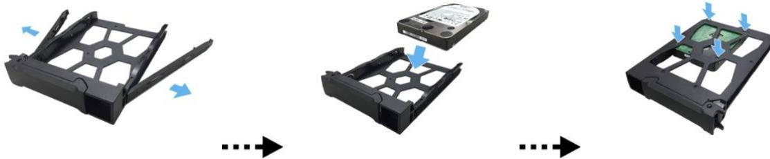
4. 握住硬盘托盘把手上方，将托盘沿着硬盘安装槽推到底，然后下压把手以固定硬盘托盘。当把手固定时，您会听到一声“喀答”。
