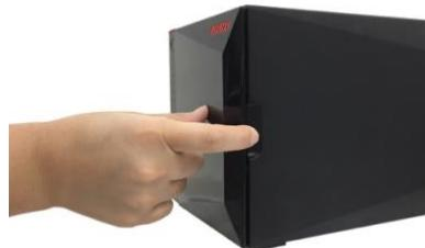
2. 依箭頭方向，將要安裝硬碟的托盤拉取出來，如下圖所示。
