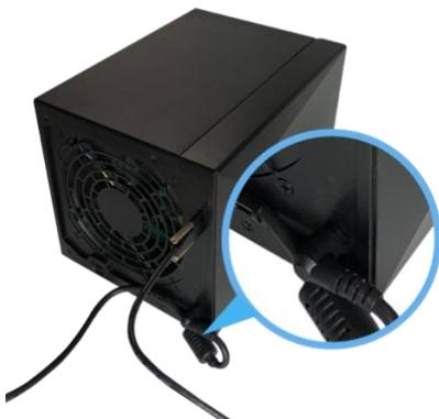
3. Verbinden Sie das andere Ende des USB 3.2-Kabels mit einem USB 3.2-Anschluss auf der Ihres NAS. Das Gerät sollte dabei noch nicht eingeschaltet sein. Wenn das NAS eingeschaltet wird, wird der AS5004U ebenfalls eingeschaltet. Wenn das NAS ausgeschaltet oder in den Ruhemodus versetzt wird, wird der AS5004U ebenfalls in den Ruhemodus versetzt.
