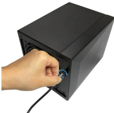
2. Verbinden Sie das Stromkabel mit dem Gerät.
