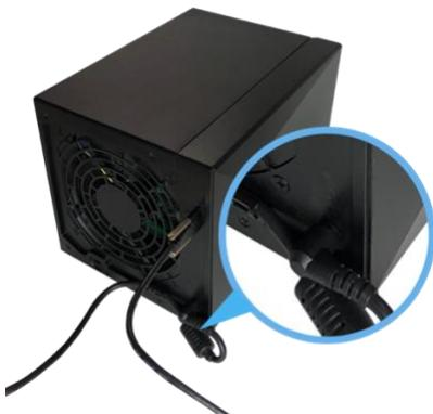
3. Connectez l'autre extrémité du câble USB 3.2 à un port USB 3.2 situé de votre NAS, qui ne devrait pas être encore sous tension. Lorsque le NAS est sous tension, l'AS5004U sera également sous tension. Lorsque le NAS est éteint ou en mode veille, l'AS5004U va également entrer en mode veille.
