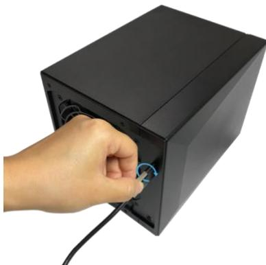
2. Connectez le câble d'alimentation à l'appareil
