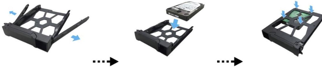
4. Far scorrere il vassoio del disco sui binari dell'alloggiamento del disco. Usando il blocco, estrarre con attenzione il vassoio del disco dal suo alloggiamento. Fissare il vassoio del disco in posizione spingendo verso il basso il blocco. Il blocco deve chiudersi senza problemi con uno scatto che deve essere percepibile. Assicurarsi di avere spinto il vassoio del disco per tutta la corsa nell'alloggiamento del disco prima di provare a chiudere il blocco.
