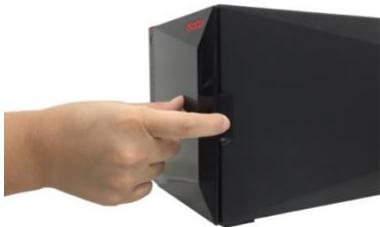
2. Usando il blocco, estrarre con attenzione il vassoio del disco dal suo alloggiamento.
