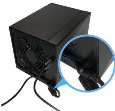
3. USB 3.2 ケーブルのもう一方の端を NAS の USB 3.2 ポートに接続します。このとき、NAS の電源はまだ入れないでください。NAS の電源を入れると、AS5004U の電源も入ります。NAS の電源を切るか、スリープモードに入ると、AS5004U もスリープモードに入ります。
