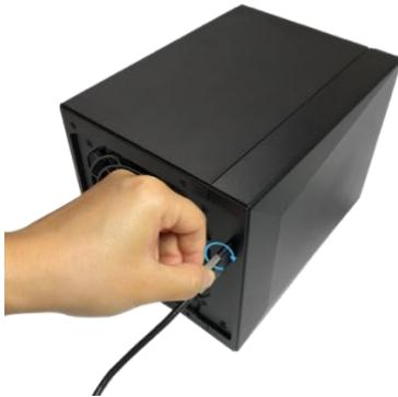
2. 電源ケーブルをデバイスに接続します。
