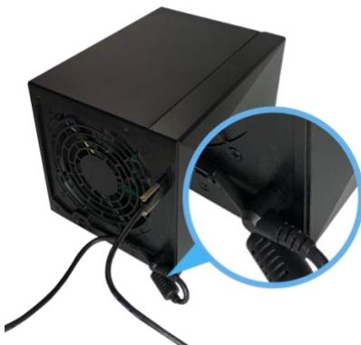
3. Ligue a outra extremidade do cabo USB 3.2 Gen2 a uma porta USB 3.2 no seu NAS, que ainda não deve estar ligada. Quando o NAS estiver ligado, o AS5004U também será ligado. Quando o NAS estiver desligado ou em modo de suspensão, o AS5004U também entrará em modo de suspensão.
