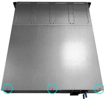
4. Greifen Sie die Abdeckung von beiden Seiten mit beiden Händen, schieben Sie sie dann zum Entfernen vom Gehäuse vorsichtig nach hinten.
