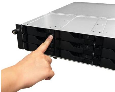
2. Ziehen Sie die Laufwerkhalterung am Riegel sanft aus dem Laufwerkschacht.
