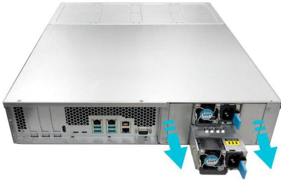
4. Prepare una nueva PSU e insértela empujando hacia dentro en la ranura hasta que se escuche un clic.
