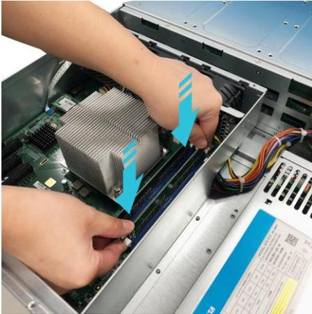
4. Con la ayuda de dos dedos, presione el módulo de memoria hacia abajo hasta que quede asegurado por los clips del eyector.
