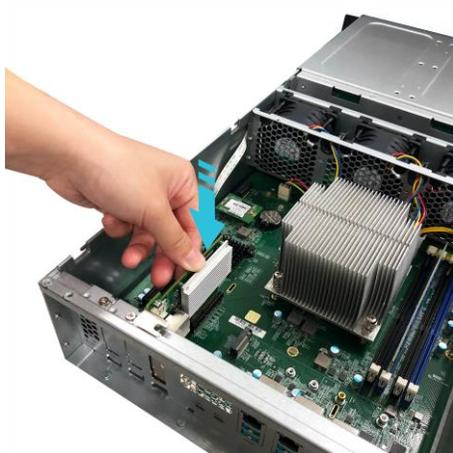
3. Con la ayuda de dos dedos, presione la tarjeta de expansión hasta que quede fija y coloque el tornillo de fijación.
