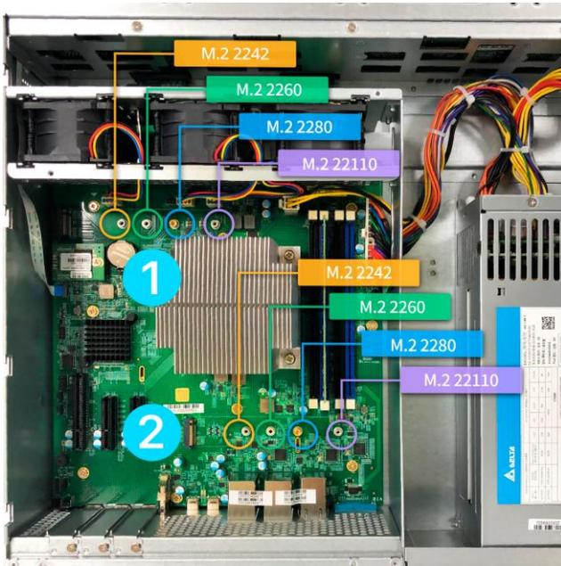
1. Insérez le disque M2 à un angle de 45 degrés et poussez-le doucement dans l'emplacement dédié.
