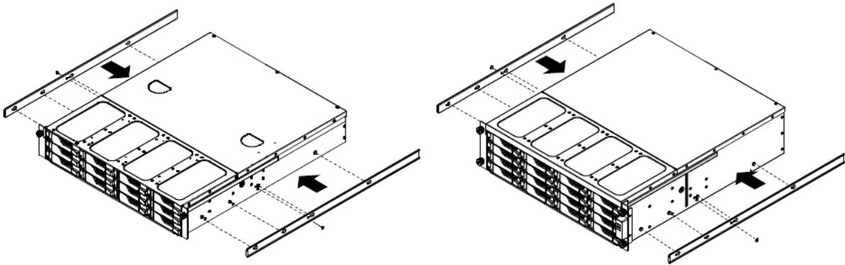
7. Montez l'assemblage de rail externe sur votre rack. Veuillez noter que l'avant et l'arrière de l'assemblage du rail externe doivent être fixés au rack avec deux vis.
