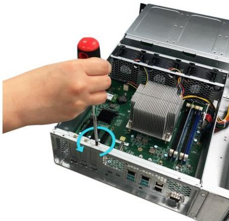
2. Insérez délicatement votre carte d'extension dans l'emplacement, en veillant à ce que le connecteur en bas de la carte d'extension soit aligné avec l'emplacement.
