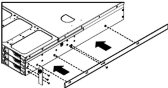
6. Montez les rails internes sur le châssis système avec les vis de montage fournies.
