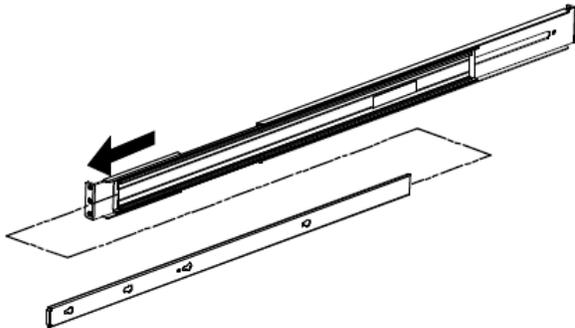
5. Alignez les trous du rail interne avec les pinces du châssis du système et poussez le rail interne à l'intérieur complètement.
