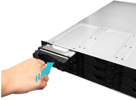
5. Une fois le loquet fixé, vous pouvez le verrouiller avec le verrou du plateau de disque. Avec un tournevis à tête plate, tournez le verrou dans le sens horaire inversé pour verrouiller le mécanisme du loquet. Tournez le verrou dans le sens horaire pour le déverrouiller.
