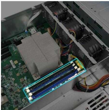
2. Lors de l'insertion du module de mémoire dans l'emplacement vide, veillez à aligner les crans sur le module avec les crans de l'emplacement.
