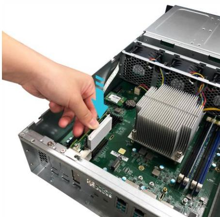
3. Осторожно прижмите плату расширения двумя пальцами, чтобы закрепить ее на месте, а затем вкрутите крепежный винт.
