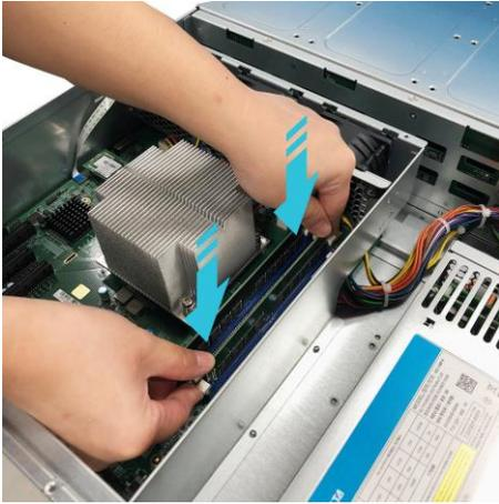
4. Осторожно прижмите модуль памяти двумя пальцами вниз, чтобы защелкнуть фиксаторы выталкивающего устройства.
