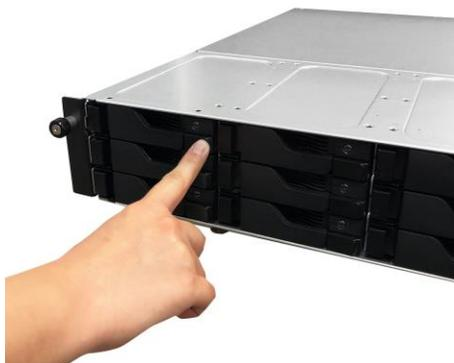
2. С помощью фиксатора осторожно вытяните лоток для диска из дискового отсека.
