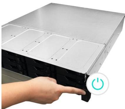
4. Устройство NAS готово к работе после того, как зеленый индикатор состояния системы перестает мигать и горит постоянно. В этот момент подается звуковой сигнал зуммера системы. После этого установка оборудования будет завершена. Теперь для настройки системы обратитесь к руководству по установке программного обеспечения.
