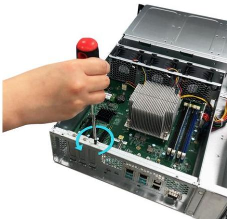
2. Осторожно вставьте плату расширения в гнездо, совмещая разъем в нижней части платы расширения с гнездом.
