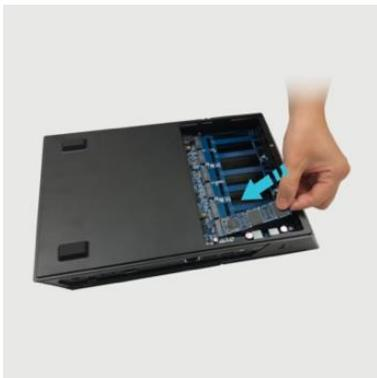
5. Nach dem Einsetzen drücken Sie die SSD nach unten, so dass sie bündig mit der Hauptplatine abschließt, während Sie den SSD-Verriegelungshebel öffnen, um die SSD zu sichern. Sobald die SSD vollständig eingeschoben ist, lassen Sie den Hebel los, um die SSD zu sichern. Falls Kühlkörper benötigt werden, sollten diese jetzt installiert werden.
