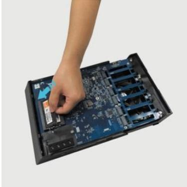
2. Drücken Sie das DIMM vorsichtig so weit nach unten, bis beide Verriegelungen einrasten. Das RAM sollte nun mit der Hauptplatine auf gleicher Höhe abschließend sein.
