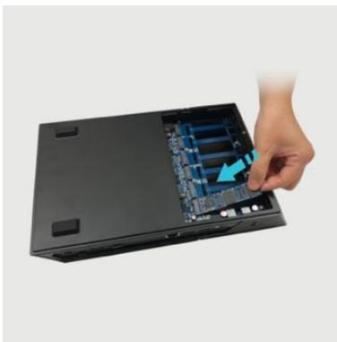
5. SSD を挿入したら、SSD ロックレバーを押しながら、SSD がマザーボードと同じ高さになるように押し下げ、SSD を固定します。SSD が完全に同じ高さになったら、レバーを放して SSD を固定します。ヒートシンクが必要な場合は、今すぐ取り付ける必要があります。
