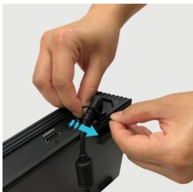
4. バックルを矢印の方向に締め付けます。
