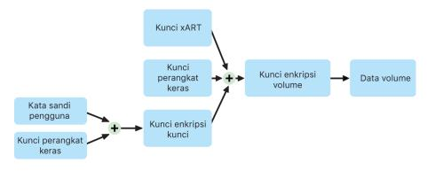
Di Mac dengan Apple silicon dan Mac dengan keping T2, semua penanganan kunci FileVault berlangsung di Secure Enclave; kunci enkripsi tidak pernah terpapar secara langsung ke CPU Intel. Secara default, semua volume APFS dibuat dengan kunci enkripsi volume. Konten volume dan metadata dienkripsi dengan kunci enkripsi volume ini, yang dibungkus dengan kunci enkripsi utama (KEK). KEK dilindungi oleh kombinasi kata sandi pengguna dan UID perangkat keras saat FileVault dinyalakan.
