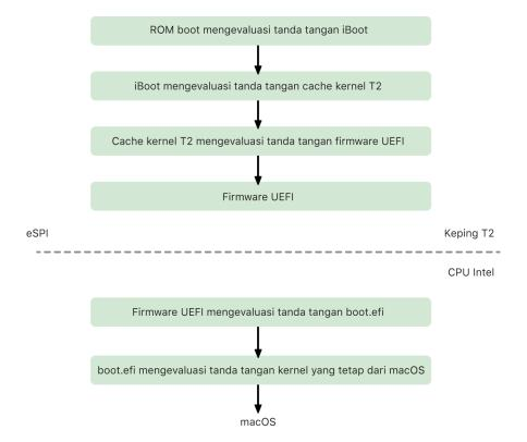
Setelah verifikasi, image firmware UEFI dipetakan ke bagian memori keping T2. Memori ini dibuat tersedia bagi CPU Intel melalui Antarmuka Periferal Serial yang ditingkatkan (eSPI). Saat melakukan boot untuk pertama kalinya, CPU Intel mengambil firmware UEFI melalui eSPI dari salinan firmware yang telah diperiksa integritasnya dan dipetakan ke memori, yang terdapat di keping T2.
