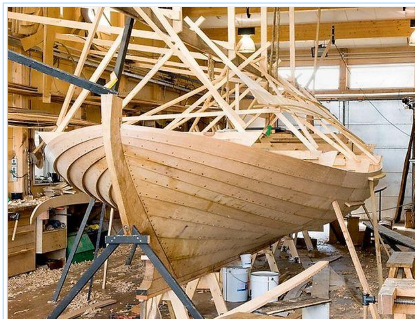
Vikingskibsmuseets bådeværft bygger nye klinkbyggede både. Her med udgangspunkt i en 1905-Åle drivkvasse fra Fejø. Frivillige bådelaug sejler og hjælper til med at vedligeholde bådene. Foto: Werner Karrasch Vikingskibsmuseet.
