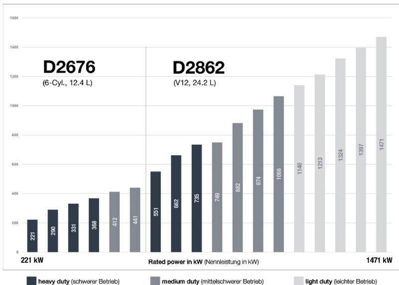
*MAN Engines deckt ein breites Leistungsportfolio von 221 bis 1.471 kW in der Emissionsstufe IMO Tier III ab.*
