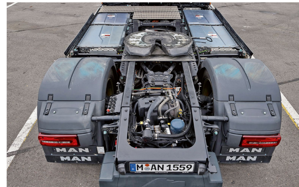
Die Kardanwelle begrenzt den Platz, daher fahren beim eTGX maximal 534 kWh mit
