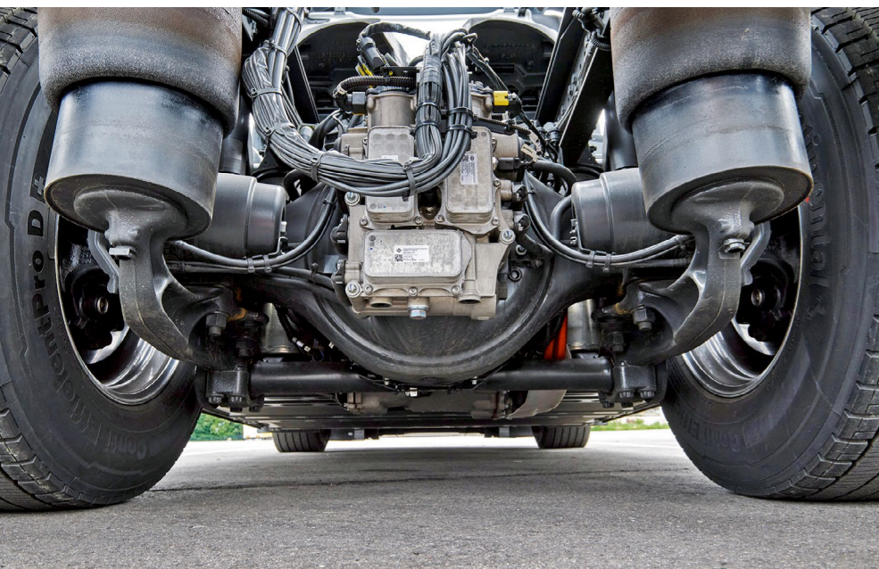
E-Achse mit zwei Elektromotoren plus automatisiertem Vierganggetriebe
