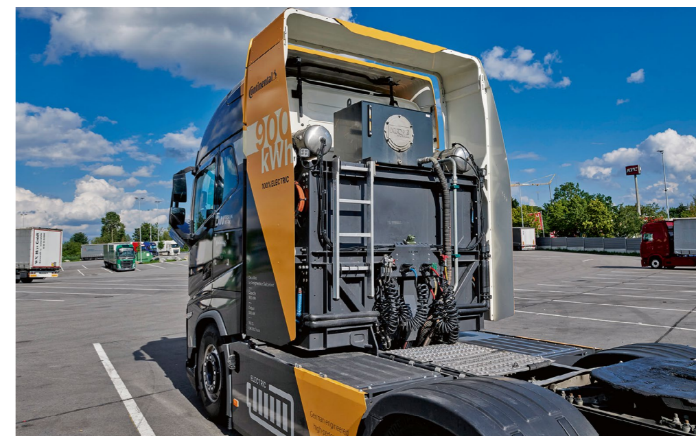
Zwei der vier Batteriepakete platziert Designwerk im Turm hinter der Kabine
