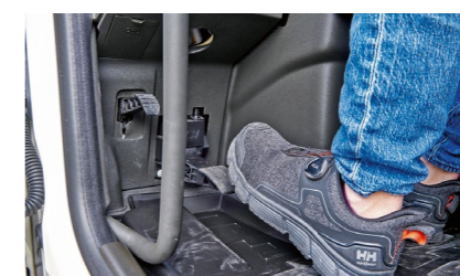
Top: stufenlose Rekuperation per Pedal
