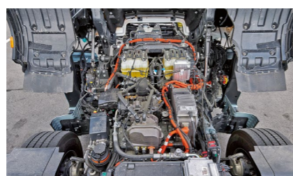
Nebenaggregate unter der Kabine
