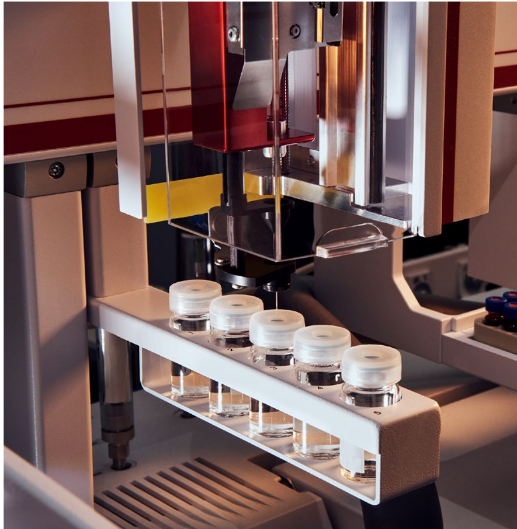
Nous évaluons dans les matériaux la présence de substances faisant l'objet d'une restriction dans notre Liste des substances réglementées, notamment les COV, à l'aide d'équipements tels que ce système de chromatographie gazeuse/spectrométrie de masse (CPG/SM).
