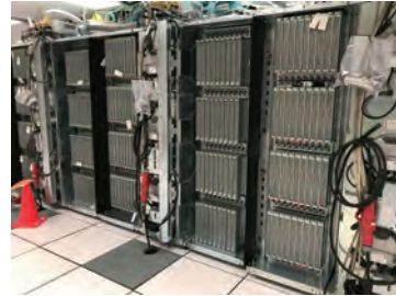
SGI ICE XA のキャビネット (フロントドア・パネルを外した状態)
