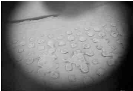
写真 2 還元帯の炉内状態 Photo 2 Inner vision of the furnace
