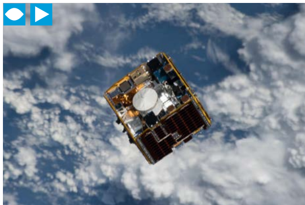
图为国际空间站部署的NanoRacks-Remove Debris卫星。该卫星旨在演示主动清除碎片的关键技术，以减少空间碎片带来的风险。◆ 2018年6月20日/美国宇航局图片
